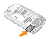
取下电池盖,插入记忆卡,使金色触片朝下。取出记忆卡
